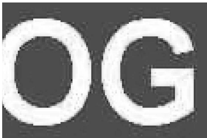
Bild 4: Die beobachtbaren Pixelfehler haben ihre Ursache in der Fourieranalyse, die im Rahmen der Bildkompression beim JPEG-Format eingesetzt wird.
