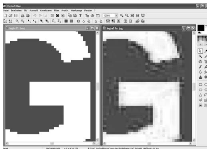
Bild 3: Der durch die Digitalisierung verursachte Treppenstufeneffekt tritt bei komprimierten und unkomprimierten Grafikformaten gleichermaßen auf. Das Gibbs'sche Phänomen dagegen ist nur bei der JPEG-Grafik zu sehen (rechtes Bild).
